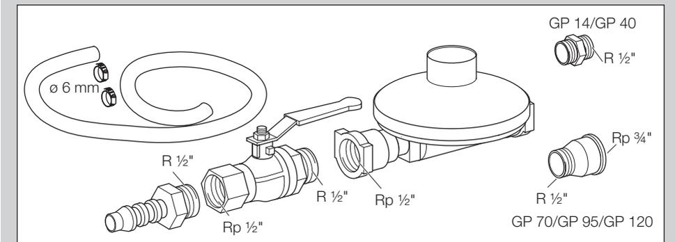
Manorreductor, válvula de bola, tubo flexible (longitud = 2 m), 2 abrazaderas para tubo flexible, racor doble R 1/2" para GP 14/GP 40, pieza de reducción R 1/2 - Rp 3/4" para GP 70 - GP 120, para conectar el grupo compacto de gas CG al suministro de gas, n.º de referencia: N52600025
