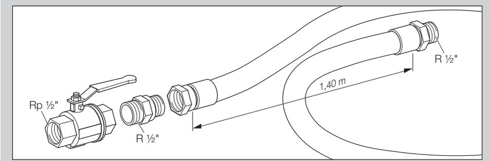
Set de conexión GP 40: conexión roscada R 1/2", longitud total = 1,50 m, n.º de referencia: N52600073
