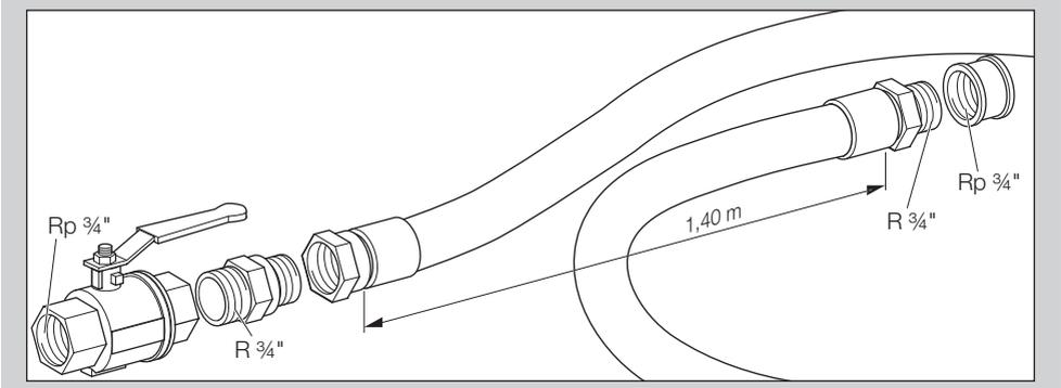
Set de conexión: conexión roscada Rp 3/4", longitud total = 1,50 m, n.º de referencia: N52600072
